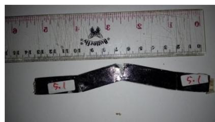
**Gambar 7.** Patahan spesimen *impact*
